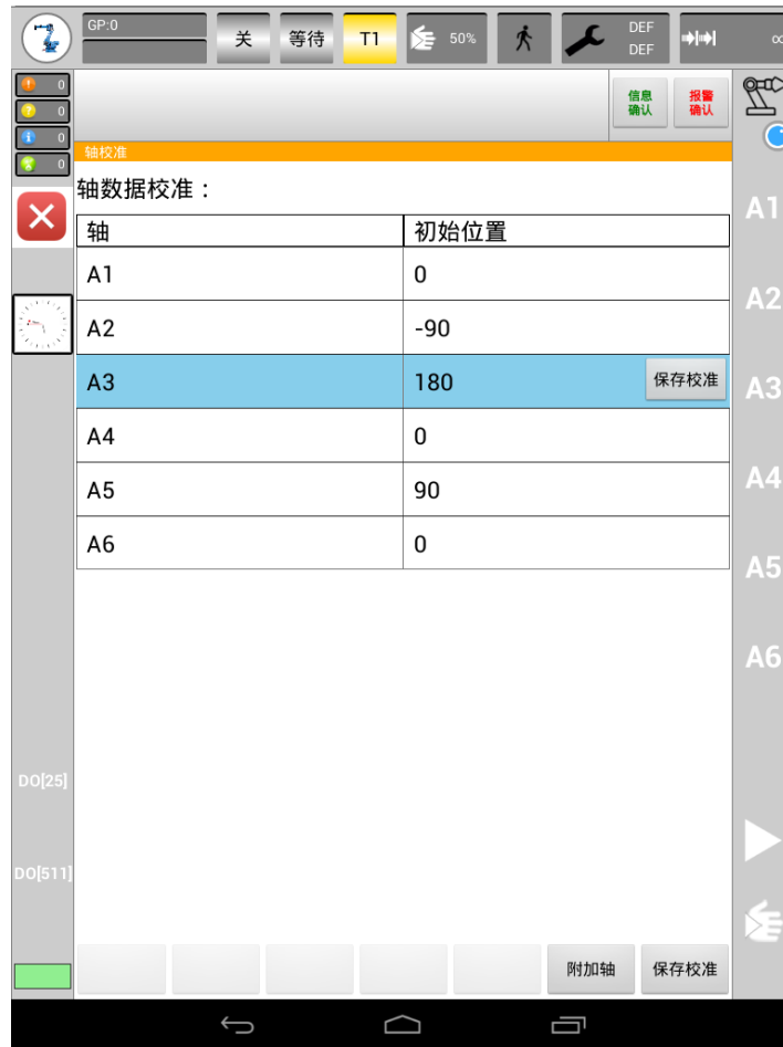
图 4-5 轴零点校准数据
