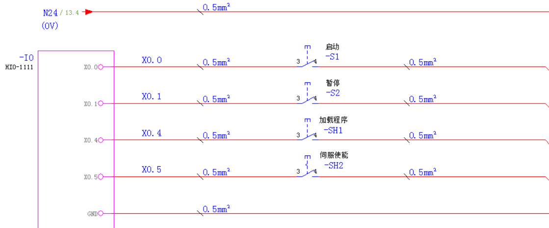
图 5-1 HIO-1111/HIO-1811N 子模块 (NPN 型) 输入信号连接电路图
